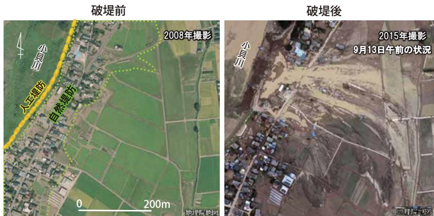
写真1 常総市上三坂付近の破堤前の状況(左)と
