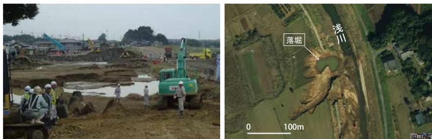
写真2 鬼怒川の破堤で形成された落堀<sup>3)</sup>
