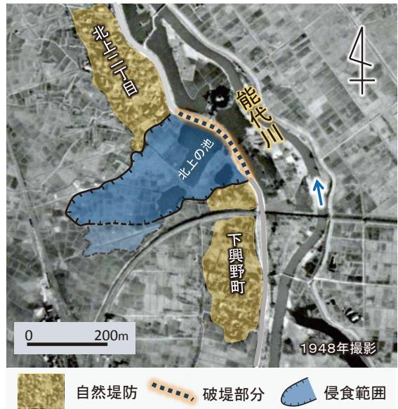
図1 落堀(北上の池)形成時の洗掘範囲
